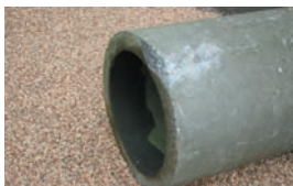
Rohre mit beschädigter Oberfläche.
