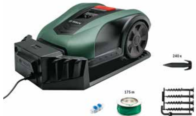
Roboter-Rasenmäher Indego M+ 700 (BOSCH) Für Gärten bis zu 700 m 2 , intelligentes und autonomes Mähen, berechnet effizienteste Mähroute, per App steuerbar, BorderCut, Hindernissensor, meistert Steigungen bis zu 27 %, SmartMowing orientiert sich an aktuellem Wetter, 18 V. WH: 3427709 € 999,-/Stück
